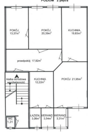
UPROSZCZONY SZKIC LOKALU MIESZKALNEGO NR 3 Bolesławiec, ul. Wybickiego 3 /dz. nr 10/4, IX obręb/ Instalacje: elektryczna, wodna, kanalizacyjna, gazowa wykonalne pomieszczenia: powierzchnia 5,05 pow. użytkowa - 116,80m 2 POZIOM 2 piętra
