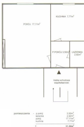
UPROSZCZONY SZKIC LOKALU MIESZKALNEGO BOLESŁAWEC ul. Ogrodowa 2 nr 8 działka nr 242, IX obręb ewidencyjny poziom II piętra instalacje: elektryczna, wodna, kanalizacyjna, gazowa wysokość pomieszczeń - powyżej 2,50m
